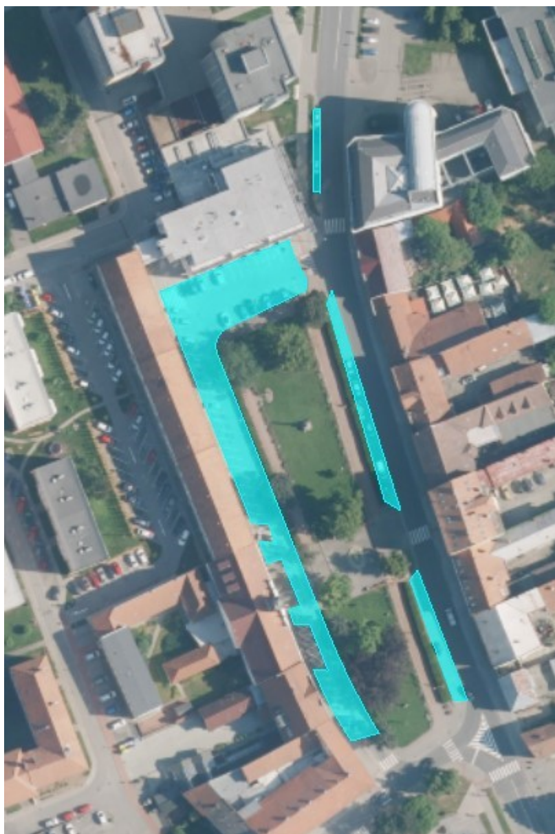
placená stání nám. Svobody a ul. Bezručova: ulice Bezručova – podélný parkovací pruh mezi kruhovou křižovatkou a nám. Svobody, nám. Svobody – dva parkovací zálivy s podélnými parkovacími místy, nám. Svobody – šikmá stání v jednom směru od ulice Rožmitállova a kolmá stání po obou stranách komunikace před bytovým domem nám. Svobody 1711/8b
